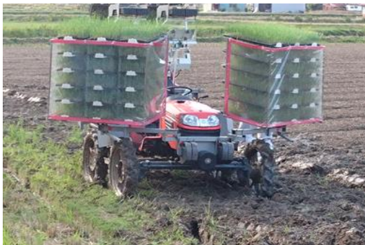
R4 導入機械：乗用型タマネギ移植機
