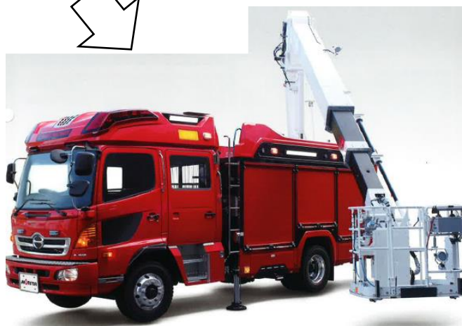
13mブーム付多目的消防ポンプ自動車 900Lのタンク水を積載、C A F S (泡消火薬剤を混合して、圧縮空気をういて発泡させる装置)を装備
