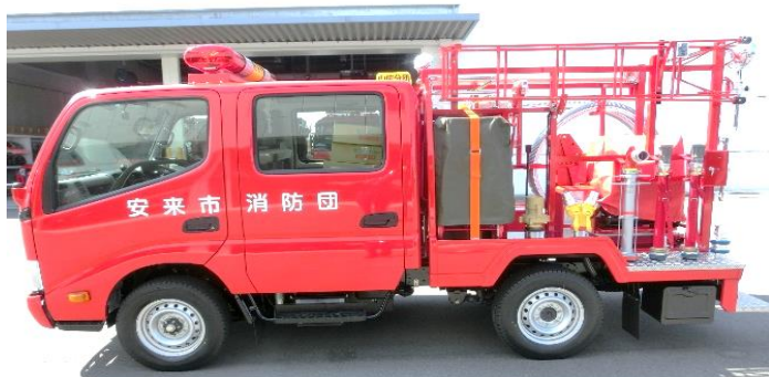
小型動力ポンプ付積載車（布部分団5班）
