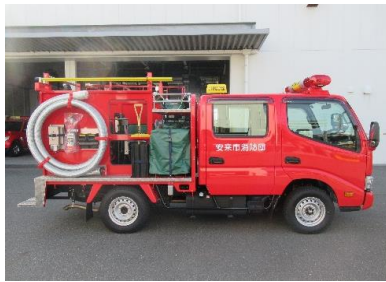
小型動力ポンプ付積載車（井尻分団配備）
