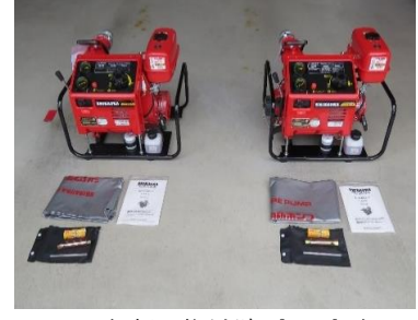
C-1級軽可搬消防ポンプ2台
