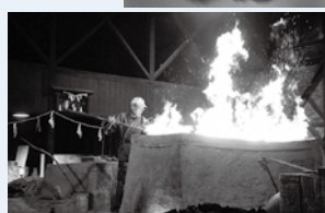
▲たたら操業（炉から炎が燃え上がる様子）
