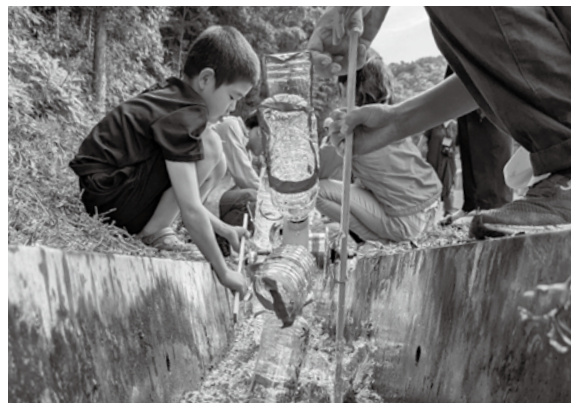
▲水車で実験する参加者。水車が回ると取り付けた豆電球が光り、発電できたことを知らせます。
