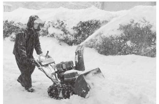
▲手押し小型除雪機。軽トラックで搬送する場合は、足下駄（ブリッジ）が必要になる施設もあります。
