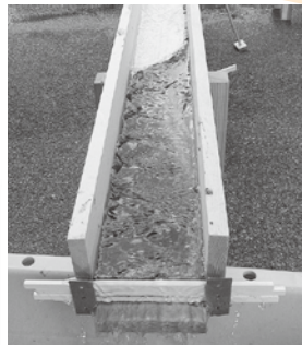
④土砂交じりから段々と黒々とした砂鉄が集まって来ました。成功です！
