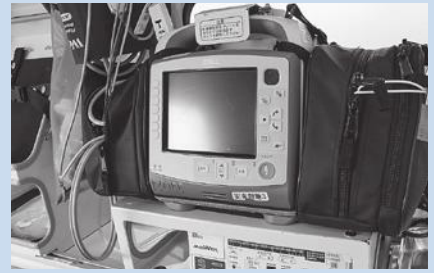
▲心電図や血圧などを測る器具。電気ショックもできます。
