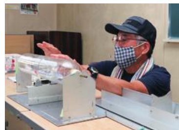
▲機体がまっすぐになっているか確認する道具。SPKのメンバーが自作したものです。
