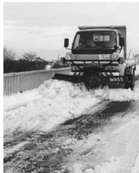
除雪作業の様子
