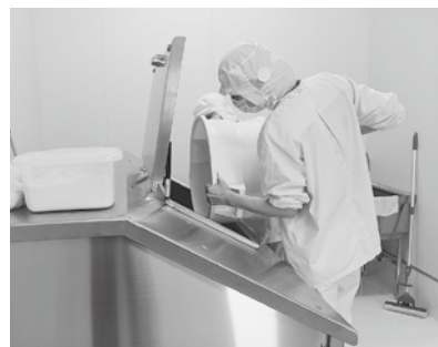
▲残飯を食品残渣発酵分解装置に投入します。
