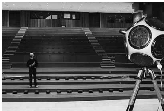
（左）残響の検査には12面体のスピーカーを使用。（右）壁面には凸凹した音響反射板。
