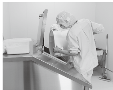
▲残飯を食品残渣発酵分解装置に投入します。
