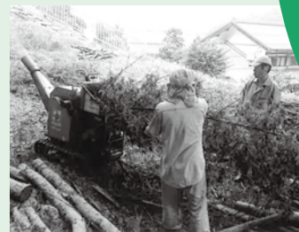
粉碎機は、伐採した竹をチップ状に粉碎することができます。
