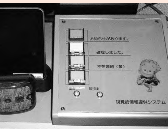
▲聞こえに不安のある人への情報伝達手段として、視覚的告知システムの開発・実証を行っています。(行政情報は電子メールで伝達。システムのランプを点灯させて、メールの送信をお知らせします)。
