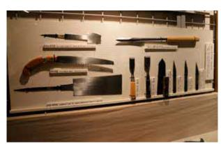
図 3-23 打刃物 (ヤスキハガネ製)
