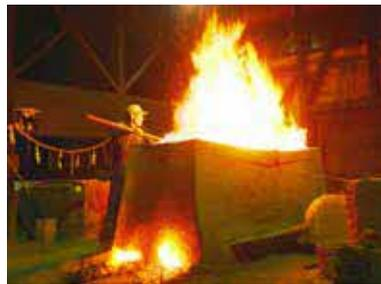
図 1-27 玉鋼製造(たたら吹き)
