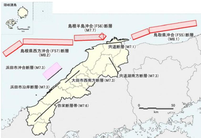
断層の位置図（海域の地震で地震動も想定した地震の断層も合わせて図示）
