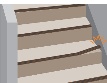
階段の滑り止めの浮き
