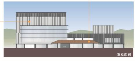
たら製鉄をイメージし、小ホールの一部のファサードにリン酸処理を施した鋼板を用いる。大観望広場の石州瓦とともに建物全体のアクセントになる。
