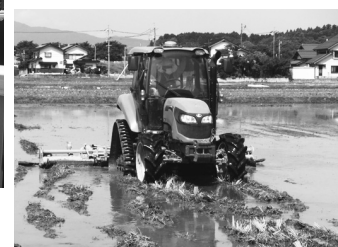
自動操舵システムによる代掻き
